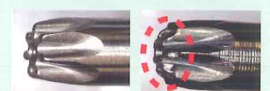
ギアの劣化→発熱・回転不良
