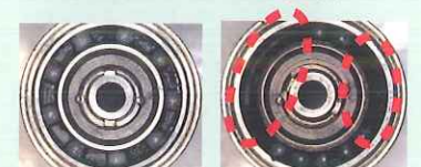
ベアリングの破損→軸ブレ・発熱
