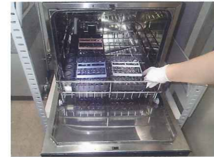
インスツルメントやコンパクトバースタンド、コンパクトファイルホルダーをしっかり固定できるので洗浄中に飛散しない
