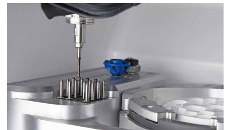
16本の標準ツールとオートツールチェンジャー
