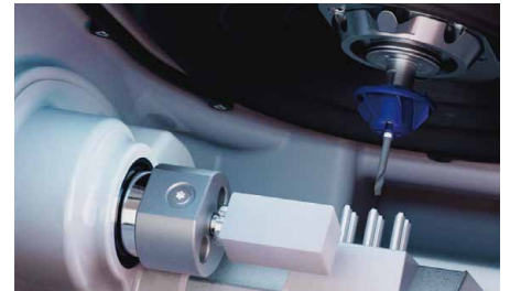
特許出願中のAIRTOOL搭載でコンプレッサー不要
