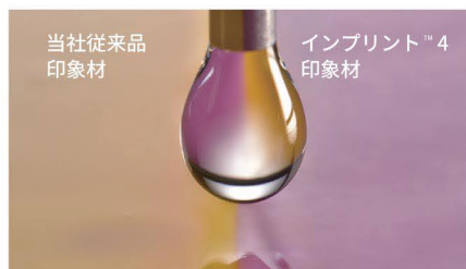
2種類の硬化前印象材（練和後40秒程度）の中心に、水滴を落とします。
