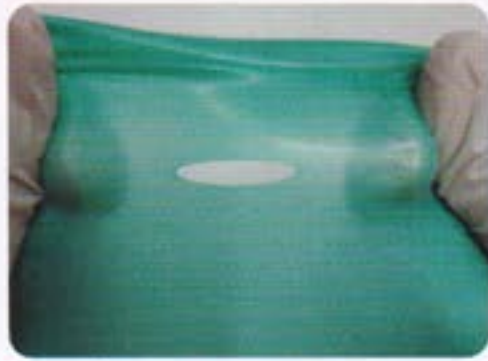
パンチで開けた穴を引き延ばしても亀裂が入らない。
