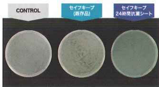
試験法規格 JIS Z 2801 抗菌性試験方法に準拠
