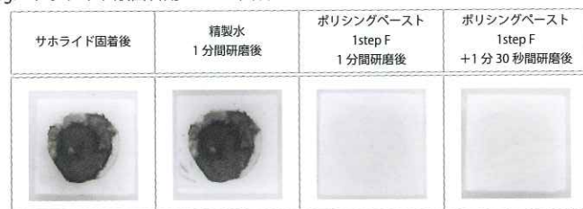
Fig.4 サホライド液歯科用 38% を固着させたアパタイトペレットに対する清掃効果
