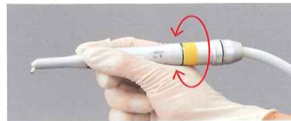
ハンドピースは、360°回転するスイベル方式を採用、チューブのねじれから解放されます。
