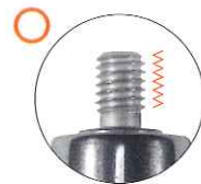
メクトロン社製の純正インサートチップを使用している正常なネジ山。
