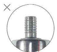
純正品以外のインサートチップを使用し変形したネジ山。インサートチップの固定ができなくなります。
