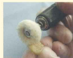
綿糸バフを用いて、付着した研磨材を拭き取るように最終艶出し研磨
