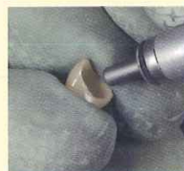
30-50μmアルミナで10秒以内のサンドブラスト処理(0.1~0.2MPa)を行った後、水洗・乾燥
