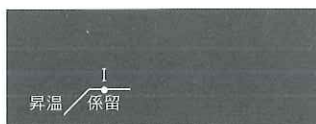
1ステージで使用する場合 室温から所定温度まで一気に上昇させる場合
