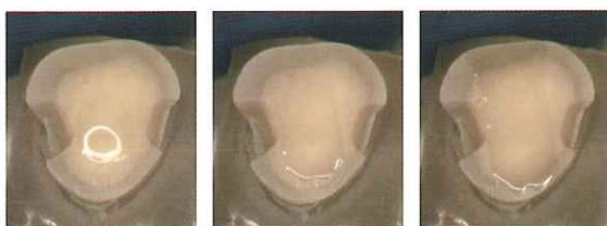
ボンディング材を塗布後、数秒で薄く自然に広がる様子
