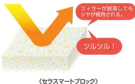
〈セラスマートブロック〉 摩耗によりフィラーが脱落しても、ナノサイズであればレジン面の凹凸が極めて小さく光沢が失われにくい。(イメージ図)
