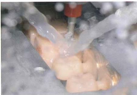
クーラント液を注水して冷却することにより、加工時の発熱を抑制します。
