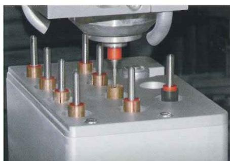
予備のバーもあらかじめセットできるため、連続加工の途中でバーが寿命時間に達しても、工具交換機能と工具長測定機能により加工途中でバーを変更する必要がなく、加工を停止させることがありません。
