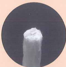
ファイバーカッタータイプ2 で切断
