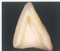
オールセラミッククラウン 切断面。チッピングはほぼな く、鋭利な断面である
