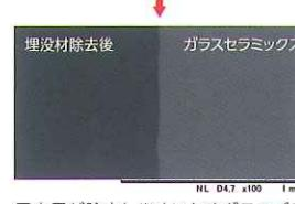
反応層が除去しやすいためガラスプラスティングだけで調整へ移行可能。
