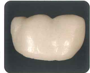
焼結後(表面粗さ: 0.641 \mu m)
