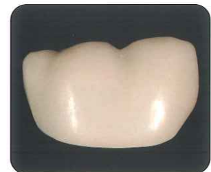
焼結後(表面粗さ: 0.246 \mu m)
