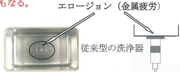
金属疲労で故障の原因が考えられます。
