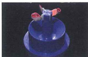
専用のインベストメントリングベースにスプレーイングをし、埋没する。
