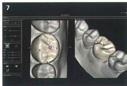
【CADデザイン】 歯冠形態の調整画面。咬合面・コンタクトポイント等のデザインを行います。
