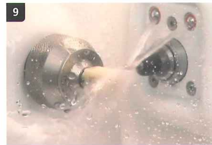
【切削】 削り出している状態。15分前後で終了します。
