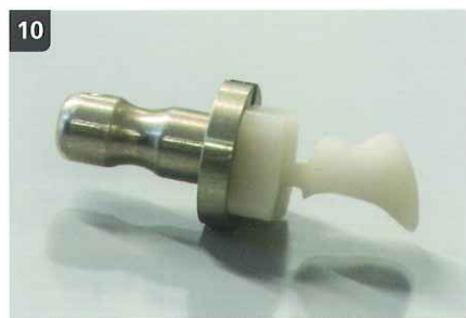
【完成】 削り上がった状態は、写真のような状態で削り上がり。クラウンを切り離します。
