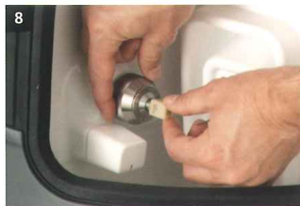
【切削】 トロフィーカムの専用バーと指示されたブロックを取り付けます。
