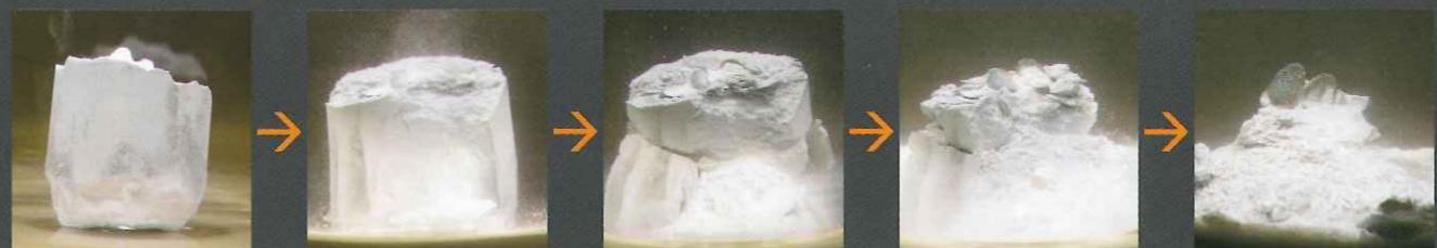
焼却後の鋳型を水中に浸漬し、崩壊性を確認。水に浸漬するだけでもスムースに崩壊します。
