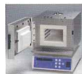
リング焼却時の有毒ガスの漏れを防ぐため扉の密閉度を改良しました。
