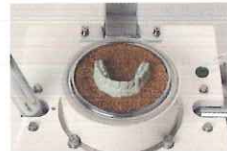
模型に高さがある場合やアンダーカットが強い場合は砂の中に模型を設置して製作します。
