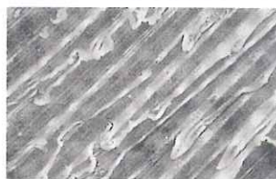
ダイヤモンドバー処理した金属面 金属面が一方向に処理されますので、 接着面積があまり大きくなりません。 メタルプライマーが流れてしまうこと もありません。
