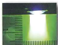
先端に光源があるため、 パワーロスが少なく、 深く浸透する光を照射可能
