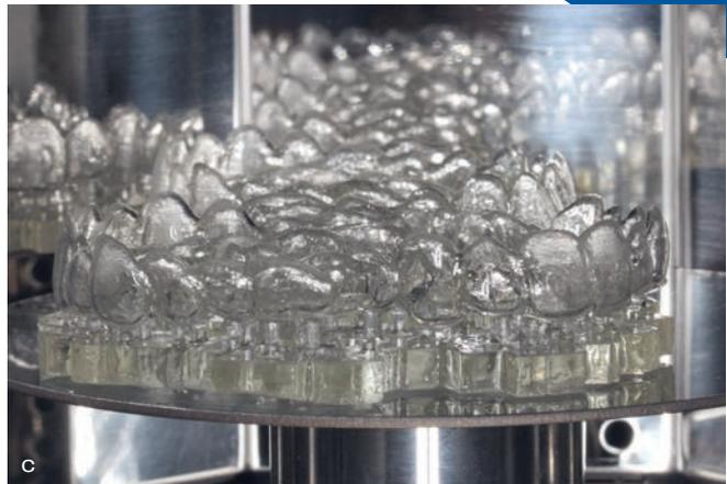
図 10-32 (a) Cure M 硬化ユニット内のアライナー。(b) 硬化したアライナー。
